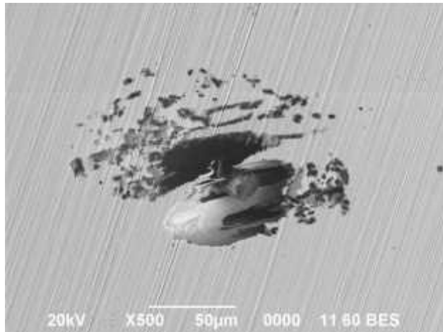
Gambar 8. Hasil SEM Produk Korosi pada Sampel 5
