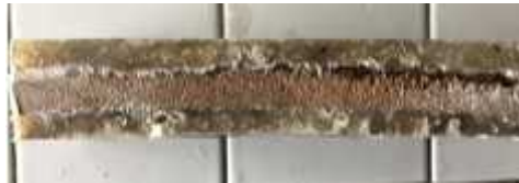
Gambar 3.5. Papan Partikel Gagal Interaksi
